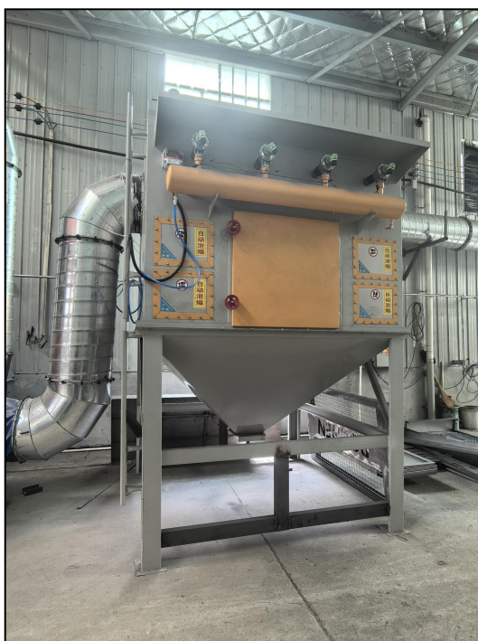
激光切割烟尘、焊接烟尘（布袋除尘器 TA001）
